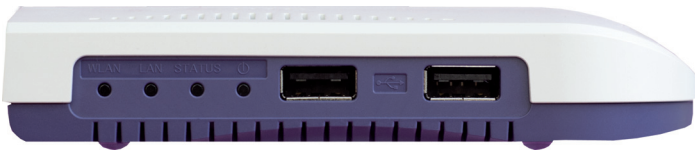
2 USB 2.0 HiSpeed-Ports und Kontroll LEDs; über optionalen USB-Hub sind max. 15 USB-Verbindungen möglich
